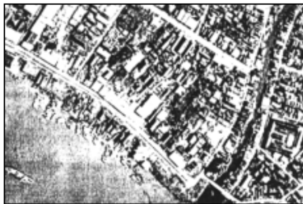
Gambar 4.7. Foto udara pankromatik hitam putih sebagian Kota Samarinda, skala 1 : 5.000 (atas perkenan Bakosurtanal).
